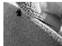
↑左写真の端反に染み込ませたラテックスを耳部分に塗布している状態
