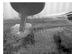
↑希釈したラテックスを塗布用の適当な大きさの端反に染み込ませた状態
