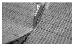
↑カッターナイフでヌキ糸の上をカットしている状態
